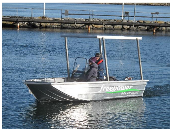
Figur 2. Prototyp efter montering av solcellsmoduler, batteri, motor, styrsystem etc.
